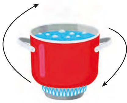
En la imagen se ilustra que el agua que está más caliente tiende a irse hacia arriba, esto es debido a que las moléculas se separan más por acción del calor, haciendo que el agua que tiene menor temperatura tienda a irse hacia abajo.
